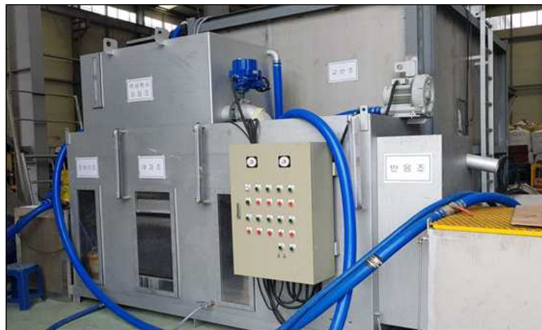
<20 m 3 규모 다기능 여과 시스템 설계도면 및 실물전경, (주)등인 보유>
